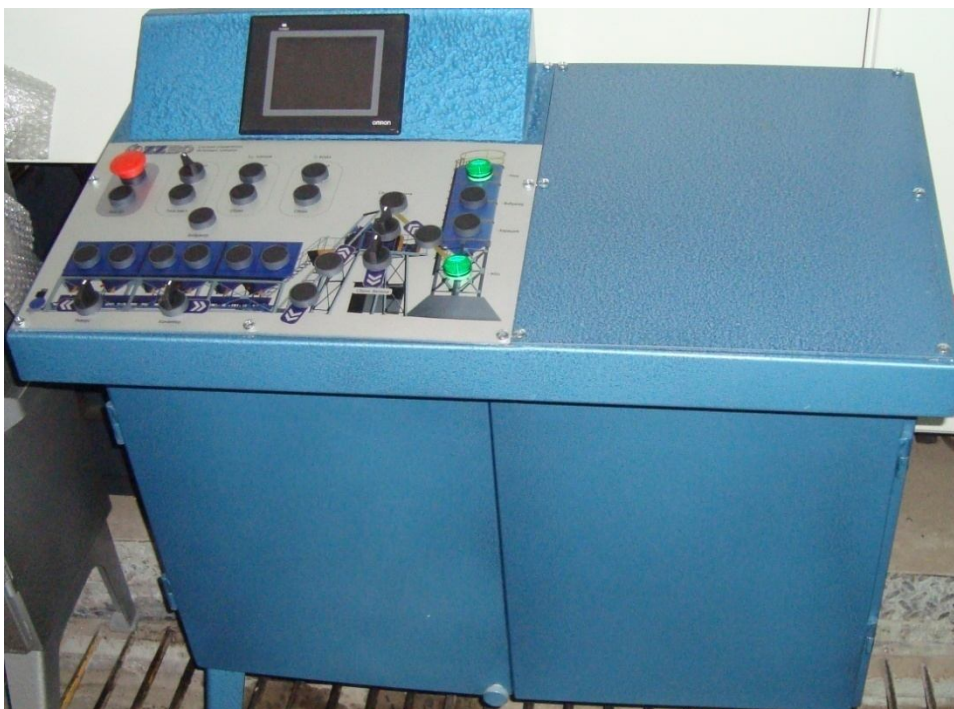
Рисунок 1 – Пульт управления растворомбетонным узлом ПА 2.0
